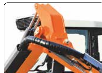
Meccanismo mobile a parallelogramma BMS (brevettato) SAB system Roll-over protective kit with inclinometer.
