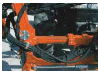
Traslazione laterale 55 cm. Offset 55 cm.
