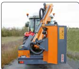
Posizione di trasporto. 4 cylinders positioned on 1st arm.
