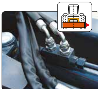
Valvola di blocco idraulico in trasporto, inserimento automatico (no catene, no staffe). Automatically activated hydraulic lock valve for transport (no chains, no brackets).
