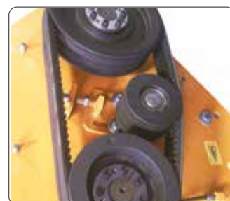
Tendicinghia a vite per il tensionamento delle cinghie. Screw type belt tensioner.
