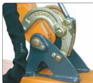
Elementi stampati per la articolazione della testata. Drop forged joint brackets for arms linkages.
