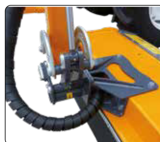
Elementi stampati per la articolazione della testata. Drop forged flailhead linkages.
