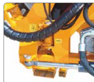
Supporto girevole scatolato. Enclosed rotating support.
