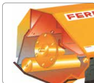
Controtelaio interno. Inner lining.
