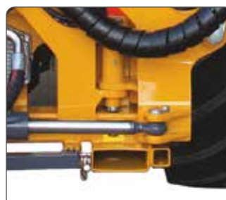
Supporto girevole scatolato. Boxed pivoting bracket.
